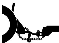
Ao acoplar o equipamento ao trator, utilize uma corrente para travar o cabeçalho do equipamento à barra de engate do trator. Esta medida evitará que as mangueiras hidráulicas venham a se romper ou que o equipamento venha a empinar em caso de quebra do sistema de engate.
