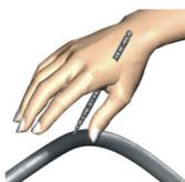
Não verifique vazamentos no circuito hidráulico com as mãos, pois a alta pressão pode provocar grave lesão.
